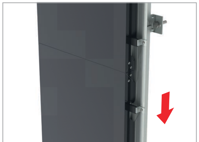
5. Colocación de la nueva bandeja de panel composite STACBOND® , con bota de cuelgue especial de 9 mm y piezas de refuerzo de cuelgue.
