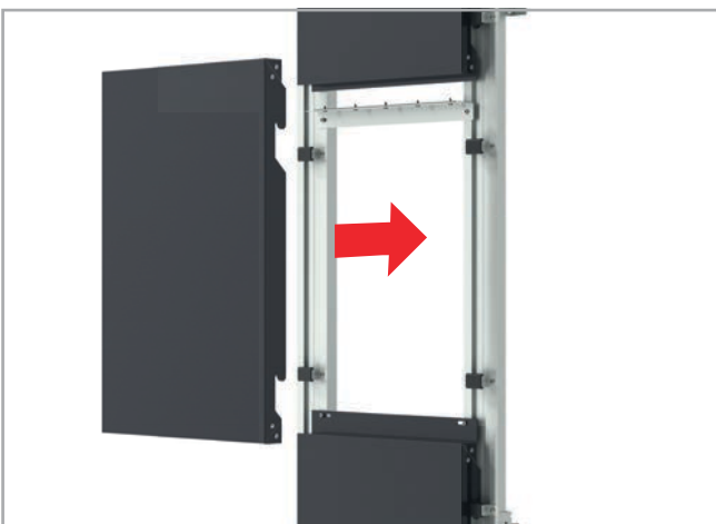
5. Colocación de la nueva bandeja de panel composite STACBOND® , con bota de cuelgue especial de 9 mm y piezas de refuerzo de cuelgue.
