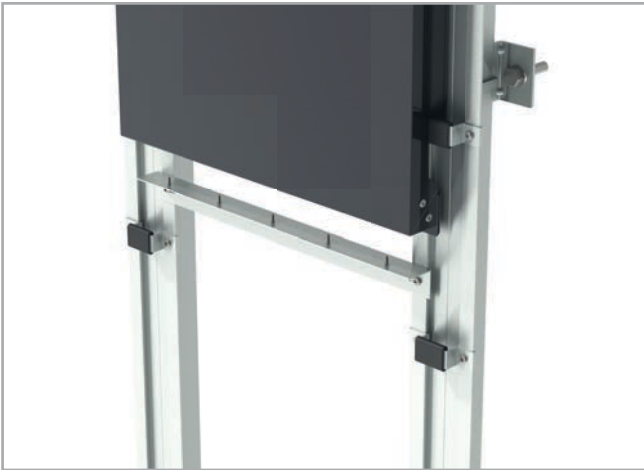
3. Colocación de tornillos 4,2 x 13 DIN 7504 N inox en perfil en "L" de 30 x 20 x 1,3 mm, y fijación de éste al perfil T OMEGA.
