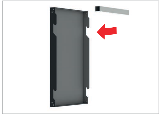
2. Perforación del tubo de 30 x 30 x 1,4 mm con \varnothing 6 mm, y situación en la nueva bandeja.
